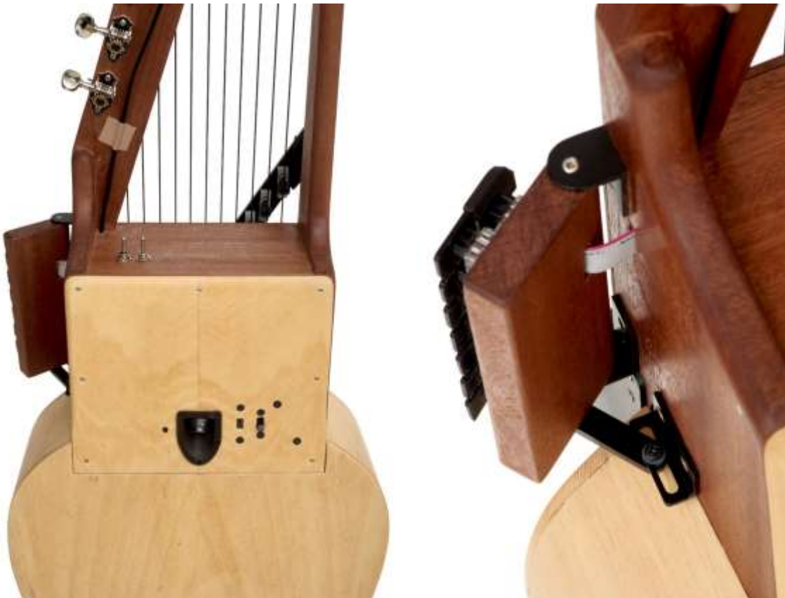
Ilustracja 16. a) detal tylnej strony Autovioli – widoczne przełączniki trybów i serwomechanizmów, gniazdo zasilania i USB, włącznik zasilania i przycisk Reset, b) detal klawiatury – widoczny zawias umożliwiający zablokowanie klawiatury pod wybranym kątem
