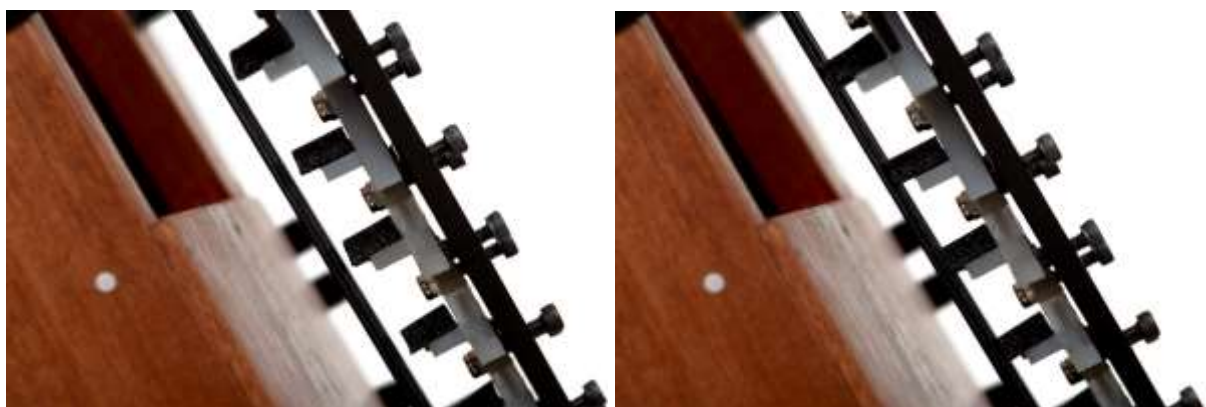
Ilustracja 15. Działanie tłumików flażoletowych Autovioli: a) tłumiki podniesione, b) tłumiki opuszczone
