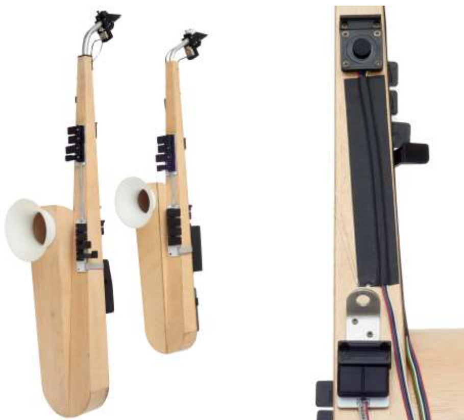
Ilustracja 46. a) porównanie rozmiarów prototypów 4. i 3. instrumentu P-D Sax, b) detal tylnej części prototypu 4. instrumentu P-D Sax: w dolnej części widoczny przełącznik oktawowy i uchwyt na pasek, w górnej – dźwignik do uruchamiania cyfrowych rozszerzeń
