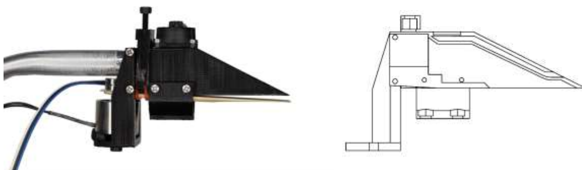
Ilustracja 41. a) ustnik prototypu 4. instrumentu P-D Sax, b) przekrój modelu 3D ustnika
