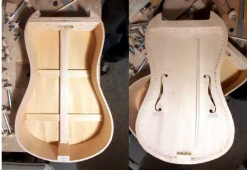
Ilustracja 12. Widok wnętrza pudła rezonansowego Autovioli w trakcie prac, widoczne ożebrowanie płyty spodniej i belka basowa na płycie wierzchniej
