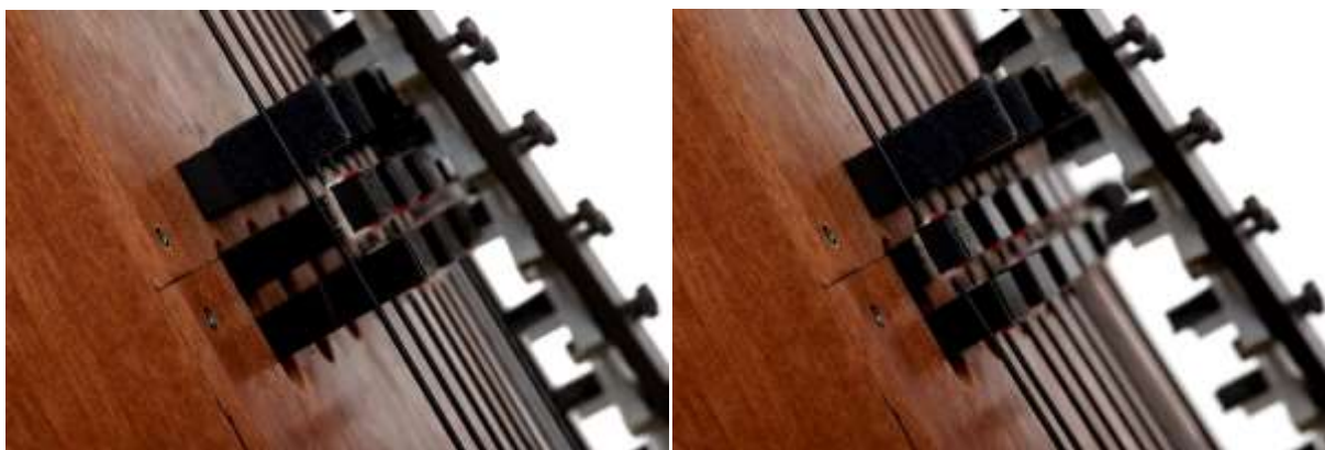
Ilustracja 14. Działanie mechanizmów strunowych Autovioli: a) wszystkie struny aktywne, b) wszystkie struny nieaktywne
