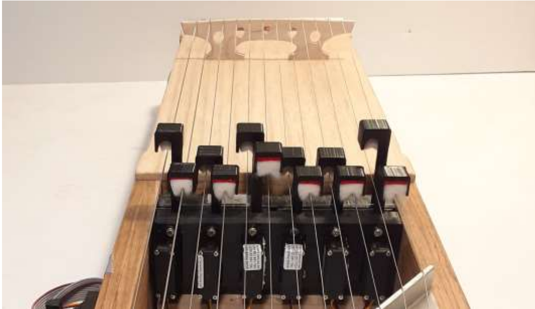
Ilustracja 10. Detal prototypu 3b Autovioli – widoczne mechanizmy w formie haczyków, przemieszczających struny w stronę płyty rezonansowej
