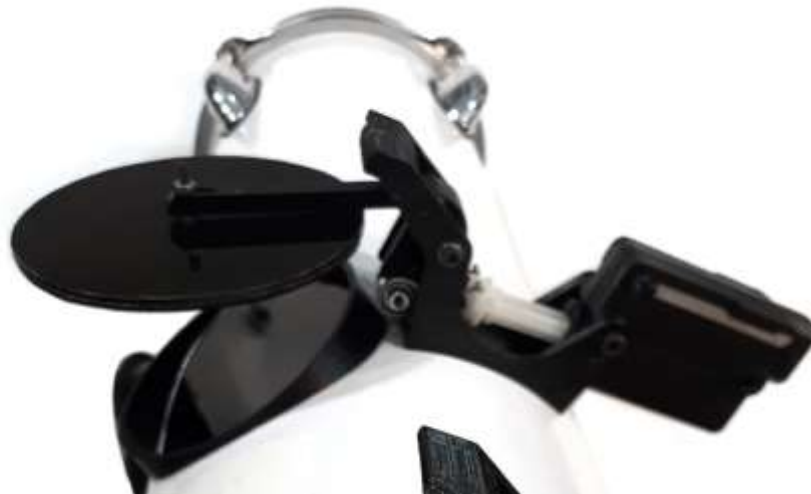
Ilustracja 22. Widok mechanizmu klapowego prototypu 2. Aeromembranophone'u
