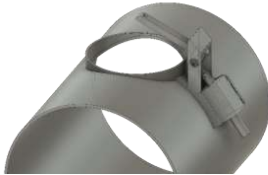
Ilustracja 21. Model 3D mechanizmu klapowego prototypu 1. Aeromembranophone'u
