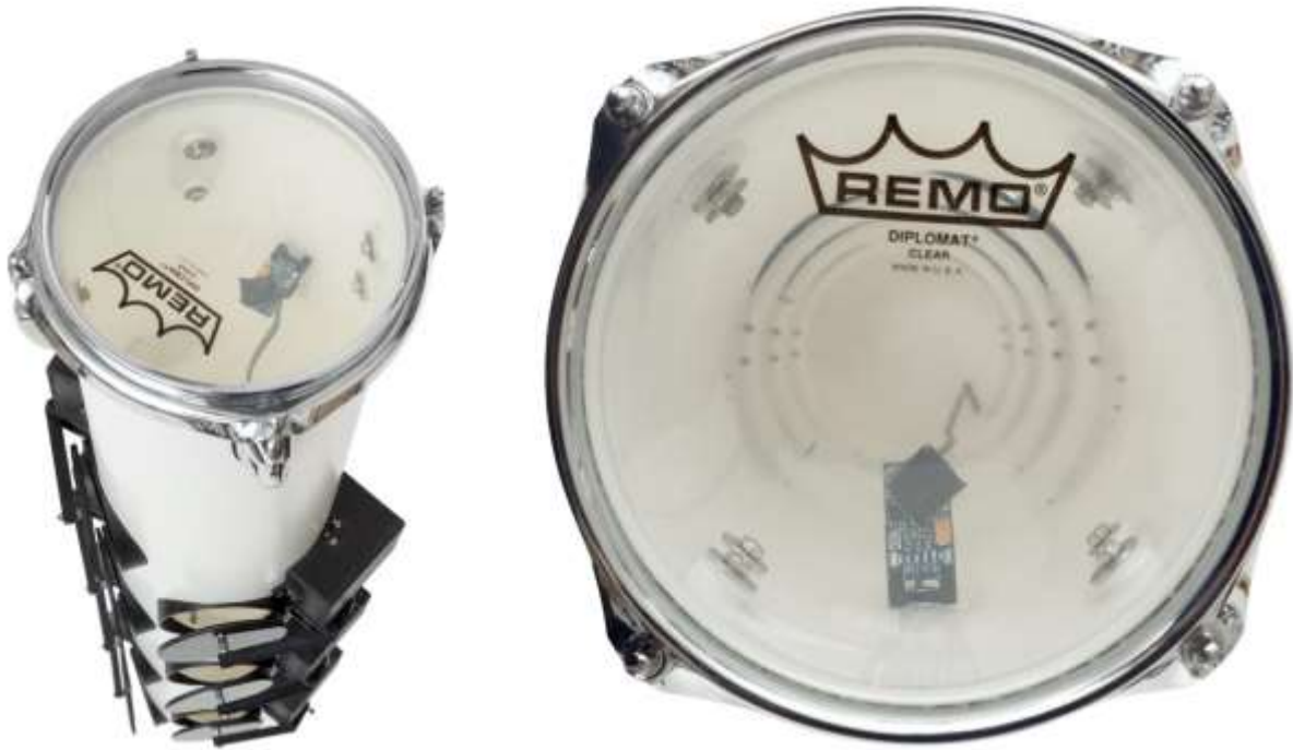
Ilustracja 28. Aeromembranophone – widok z góry, widoczny czujnik głośności
