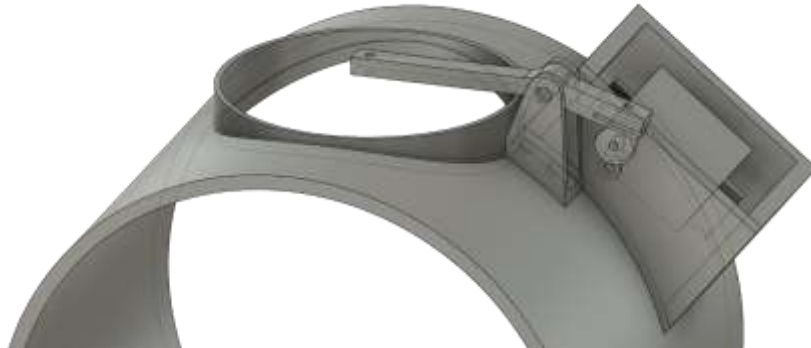
Ilustracja 25. Model 3D mechanizmu klapowego prototypu 5. Aeromembranophone'u, widoczna dźwignia klapowa oraz serwomechanizm z orczykiem zakończonym rolką, umieszczony w dodatkowej dźwiękoszczelnej obudowie
