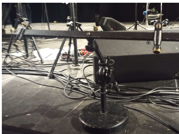
Fot. 7. Umiejscowienie mikrofonów ambientowych AKG 414 na środku sceny, na zdjęciu szyna montażowa (fot. własna)
