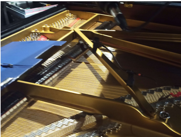
Fot. 19. Fortepian, mikrofon DPA 4099 na uchwycie magnetycznym (fot. własna)
