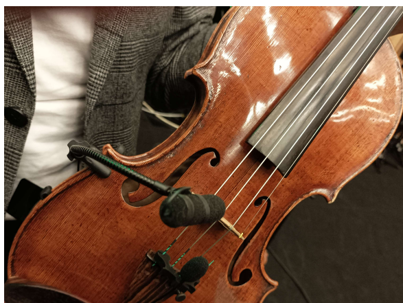
Fot. 11. Mocowanie mikrofonu DPA 4099 do skrzypiec (fot. własna)
